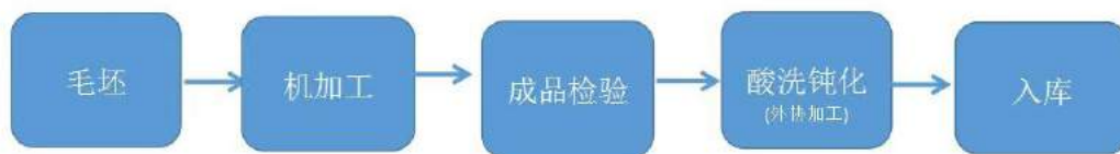
图 3.4-2 项目不锈钢嵌件生产工艺流程图
